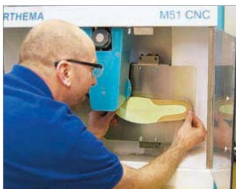
Die Einlagen werden mit Hilfe einer Fräsmaschine exakt in Form gebracht (Bild: zVg)
